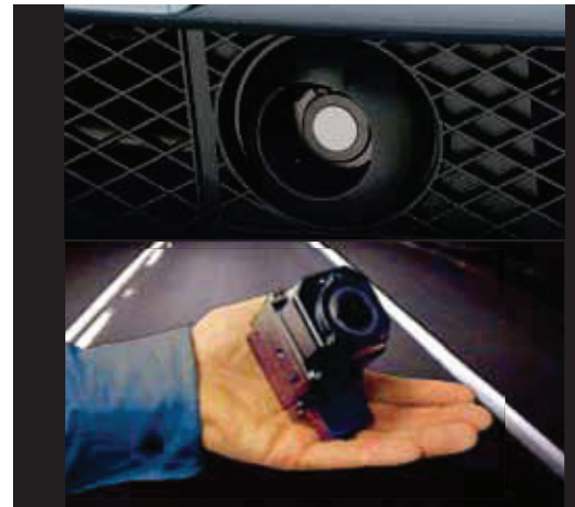
PathfindIR은 아주 작은 소형 제품으로서 그릴과 같이 차량의 한 부분에 간편하게 설치할 수 있습니다.
